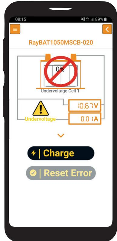
Am Ende einer jeden Fehlerbehebung, muss der Fehler zurückgesetzt werden, dies erfolgt durch Betätigung der „Reset Error“ Schaltfläche
